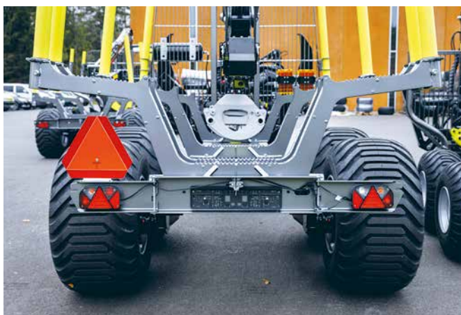
Kétféle összecusukható hátsó lámpa
