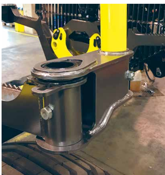
Rakodó felület bővítés forwarder típusú rakoncákhoz
