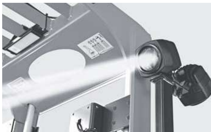
Plus de sécurité dans les entrepôts grâce à l'option STILL Safety Light
