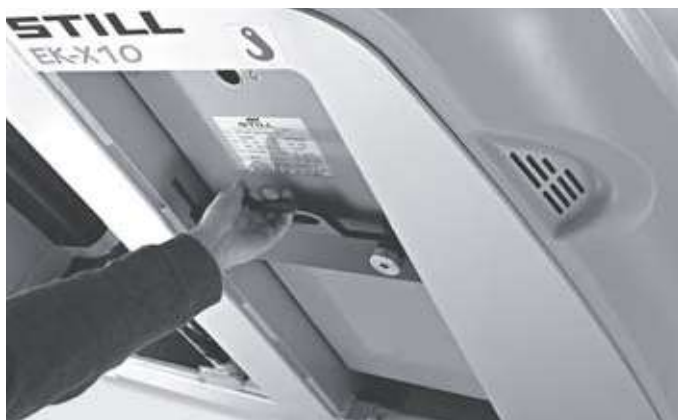
Changement de batterie simplifié et positionnement de la batterie plus sûr
