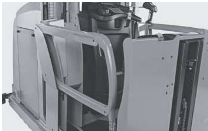
Barrières inclinables pour une préparation de commandes jusqu'au bout de la palette
