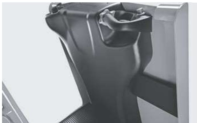
Rembourrage de genoux sur le garde-corps
