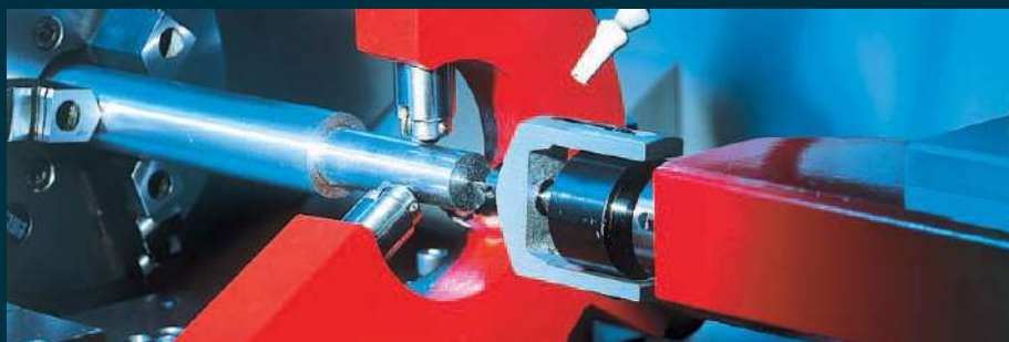
Megmunkálás álló lünetta támasszal
