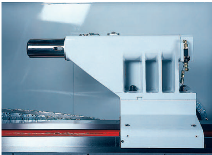
Szegnyereg csúcstámasz: Gyorsabb megmunkáláshoz a hidraulikus szegnyeregcsúcs egészen egyszerűen M parancssal be- vagy kimosztható.
