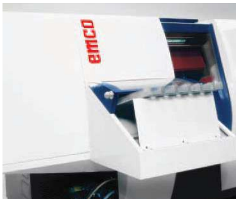
Többpályás bevezető csúszdarendszer forgás-szimmetrikus munkadarabokhoz. Egy érzékelő ellenőrzi minden vályúnál a nyers darabok meglétét.
