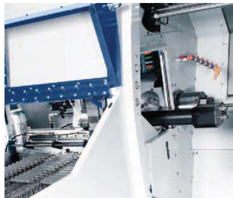
Tengelyek teljesen automatikus behelyezése ütemes szállító szalaggal. Kivétel a késztermék felfogó berendezéssel.
