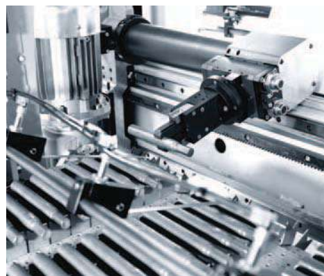
Ütemes szállító szalag prizmás feltétellel különböző módon előmunkált tengelyekhez.
