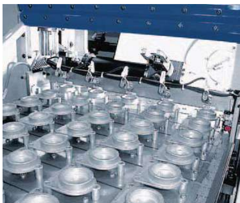
Nagy kapacitású láncos adagoló, előformázott darabok orientált betöltéséhez.
