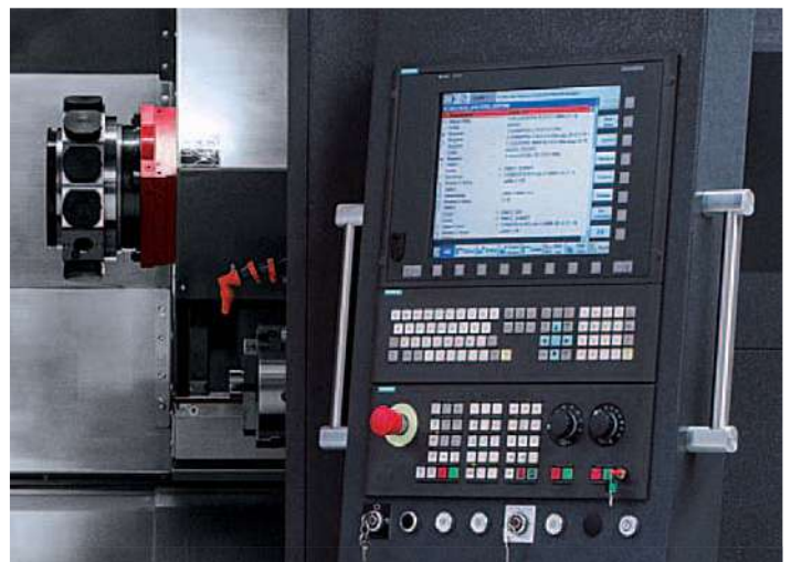
Vezérlés: A Sinumerik 840D-sl operációs kezelő felülettel illetve a Fanuc 31i Manual Guide i felszereléssel ergonomikusan, a munkatér-től jobbra van elhelyezve és kb. 80°-ban elfordítható. Vevői kívánság szerint a 10,4"-monitor helyett egy 15"-os monitor is rendelkezésre áll 100 mm-es magasság állítással és alul egy 230 V-os dugaszoló alj is, amihez villamos készülékek csatlakoztathatók.
