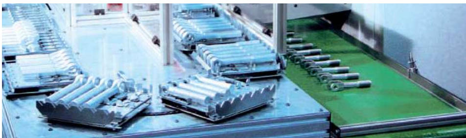
20-helyes palettás rendszer ügyélspecifikus paletta feltétekhez
