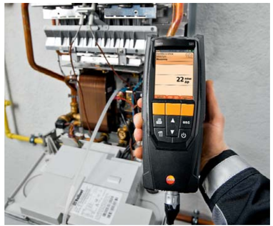
Tartozékok: Tömlő csatlakozó szett gáznymás mérésre Rend.sz. 0554 1203
