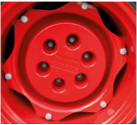
□ A kiegészítő keréksúlyokkal a hátsó tengely kapaszkodóképességét növelheti.
