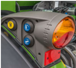
■ A hátsó sárvédőkön találhatók a kihelyezett hidraulika és a teljesítményleadó tengelycsonk (TLT) külső kezelőegységei.
