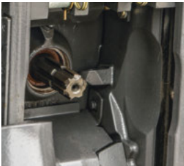
■ A teljesítményleadó tengelycsonkok a lekeskenyített és ferdén levágott profiloknak köszönhetően könnyen csatlakoztathatók.
