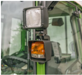
□ Az A-oszlopba épített kiegészítő munkafényszórók megvilágítják a környezetet, és óvják a növényeket.
