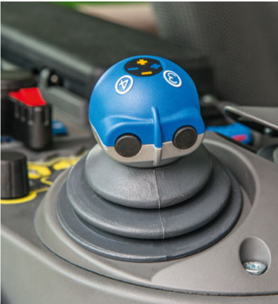
■ A harmadik és negyedik vezérlőkör az elektromos keresztkapcsoló karral nyomógombként vagy kapcsolóként működtethető.
