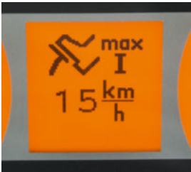
■ A beállítható működési tartományú menetpedál segítségével a traktor finoman irányítható.
