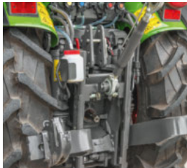
□ A gyorskiemelővel a rászerelt munkagépek lejtős területeken sem súrolják a talajt, amikor a traktor behajt a következő sorba.
