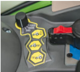
■ A kívánt TLT fordulatszámot kényelmesen beállíthatja a tekerőgombbal.
