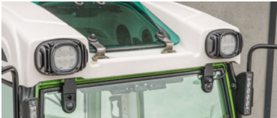
□ A tető elejénél elhelyezett erős fényű LED munkafényszórókkal messzire láthat.
