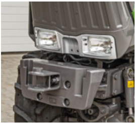
□ Ha nem szerel fel homlokrakodót, arra is van mód, hogy a kiegészítő ballasztot közvetlenül a traktoralvázra erősítse fel.
