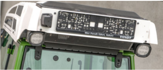
□ A hátul elhelyezett LED munkafényszóróval a csatolt munkagépeket tarthatja szemmel.
