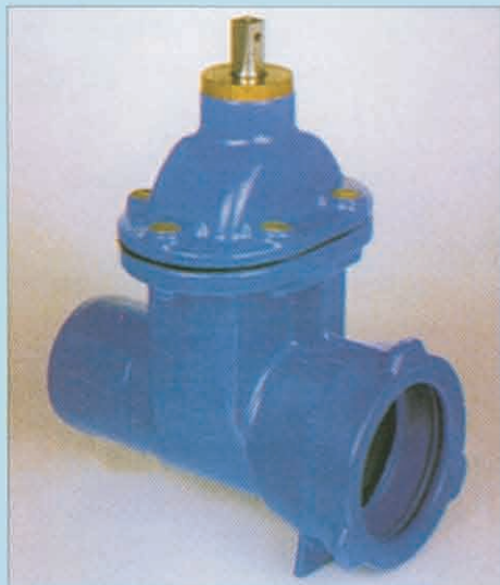
Tyton-tok, sima csővég DIN 28603 sz. DN 80-200, PN 16
