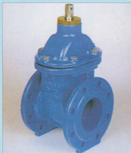
Karimás DIN 3352-4A, F4 beépítési hossz DN 40-400, PN 10/16
