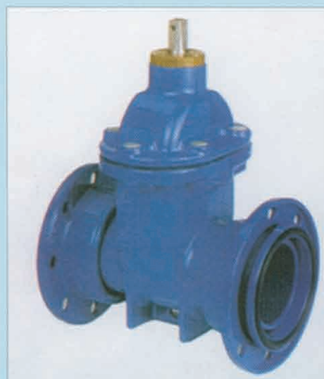
Cseretolózárlat laza krímával, F5 beépítési hossz, DN 80-200, PN 10/16
