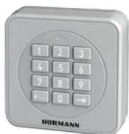
FCT 3 BS rádiós kódkapcsoló 3 funkció, nyomógombokkal, süllyesztett vagy falon kívüli szerelés lehetséges, műanyag ház világosszürke RAL 7040 színben.
