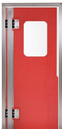
1-szárnyú kivitel Nyitásszög 2 × 180° Szélesség mm-ben: 550 – 1600 Magasság mm-ben: 1800 – 4600
