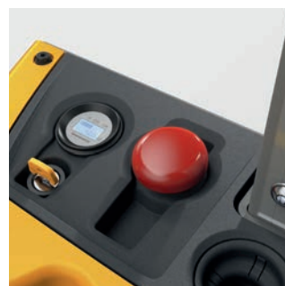
EJC M: vakamennyi fontos ellenőrző eszköz központi helyen van: akkumulátor-töltöttségjelző, üzemóraszámláló, vészkapcsoló és kulcs.
