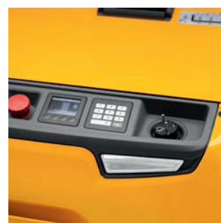
A beépített töltőkészülékkel gyorsan és egyszerűen tölthető bármely 230 V-os csatlakozónál.
