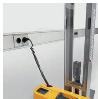
Rövid időn belül ismét üzemkész: a beépített töltőkészülék minden 230 V-os csatlakozónál újratölthető.
