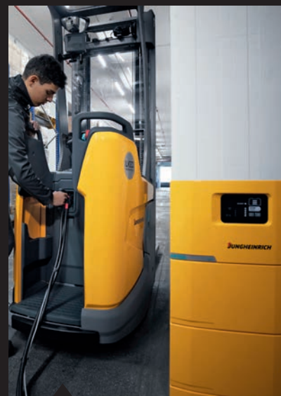
ERC 214zi/216zi komfort töltéssel. A töltőcsatlakozó ergonomikusan könnyen elérhető – a gyors és gyakori köztes töltés érdekében.
