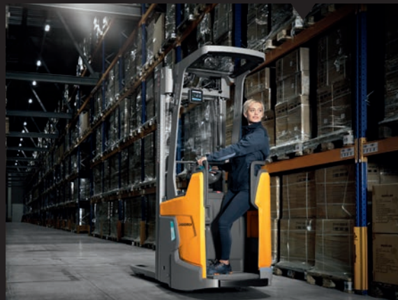
A 3-oldalú védelemmel ellátott fix kezelőállás biztonságot és ergonómiát nyújt a kezelőnek.
