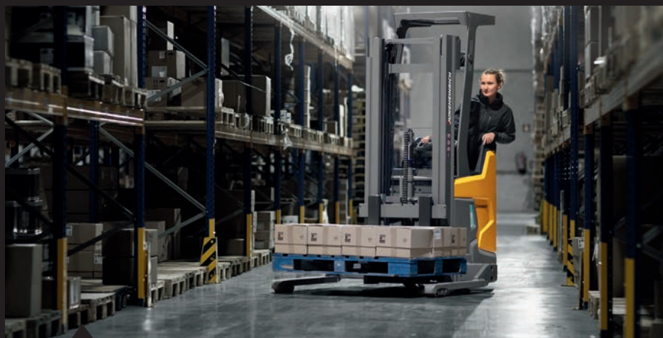
ERC 214bi/216bi: széles nyomtávú kivitel. Tökéletes különleges terhekhez és keresztirányú Euro-raklapokhoz.
