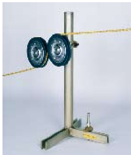
Stützrolle: Fängt Schwingungen auf
