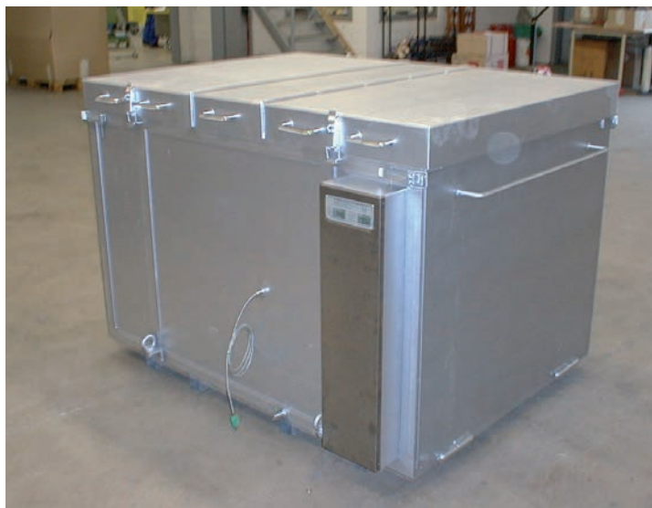
Előmelegítő és fűtőszekrény súllyesztékben kovácsolt darabok előmelegítéséhez és feszültség-mentesítő hőkezeléséhez.
