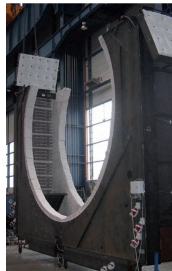
Kétrészes előmelegítési berendezés forgó nagy tartályokhoz
