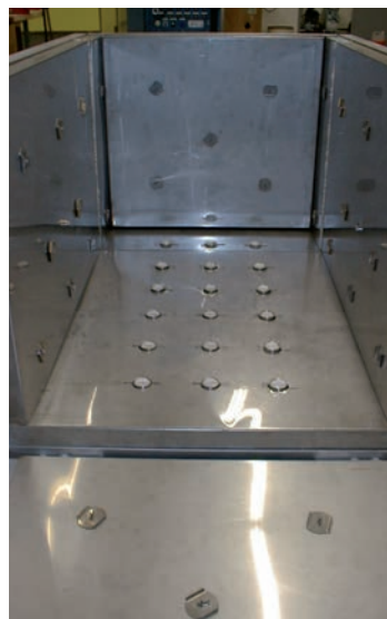
Előmelegítő és fűtőszekrény súllyesztékben kovácsolt darabok előmelegítéséhez és feszültség-mentesítő hőkezeléséhez.
