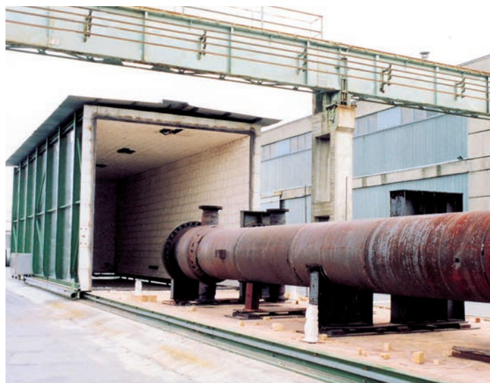
Gázfűtéses hevítőkemencék nagy tartályok feszültségcsökkentő hőkezeléséhez
