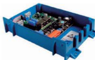
Három különböző interfész: digitális ki- és bemenet, CAN, RS485
