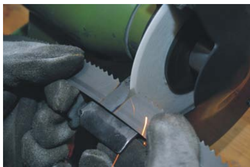
A fűrészfog kiigazítása a hegesztési zónában.
