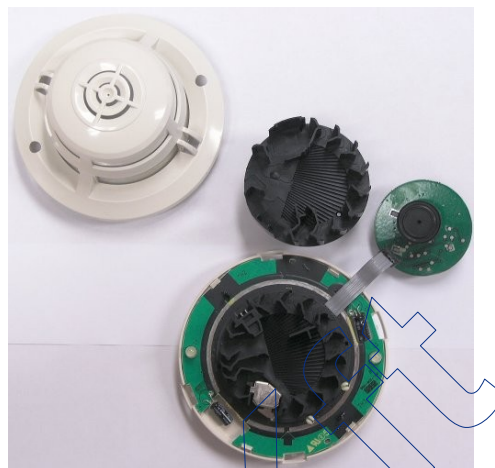
7. ábra: A kamrafedél-eltávolítása
