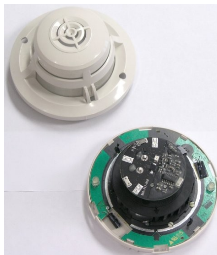
5. ábra: Az érzékelő levett fedéllel és porvédő hálójával
