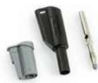
1066-IECN Csatlakozó banándugó bővítéséhez 4mm in / out Mérési tartomány: 36A / 1000V Mérési kategória: CAT III 600V / CAT II 1000V Teljes hosszúság: 5.6cm Bemeneti / kimeneti banán: Ø 4 mm
