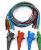
KITGSC4 Kábel és krokodil csipesz készlet Méréstartomány: 20A / 1000V Mérési kategória: CAT III 1000V Kábelhossz: 2m Krokodil csipeszek nyitása 2.3 cm Banándugók átmérője: 4mm
