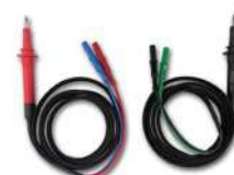
KITKELVIN KELVIN-kábel készlet A készülékkel AUTO módban gyors I-V karakterisztika mérést tesz lehetővé Érintésvédelmi osztály: CAT II 1000V AC, CAT II 1500V DC Méréstartomány: 1500V / 15A DC Sleeve-protected tip Kábelhossz: 1.5m Mérőcsúcs hossza: 15cm Banándugók átmérője: 4mm
