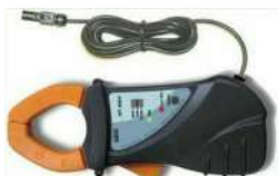
HT4004: AC/DC lakatfogó, 10 / 100 A, CAT III 600V, pofanyílás: 32 mm
