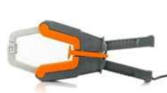
HP30C3: AC lakatfogó, 200 / 3000 A, ±0.5% a mért értékre, CAT III 600V, pofanyílás: 70 mm
