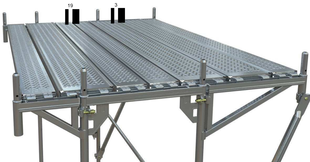
31. ábra Szoros járólap illesztés 0,36 m konzolnál (belső) és 0,73 m konzolnál (külső) - 0,32 m és 0,19 m széles járólapok használatával
