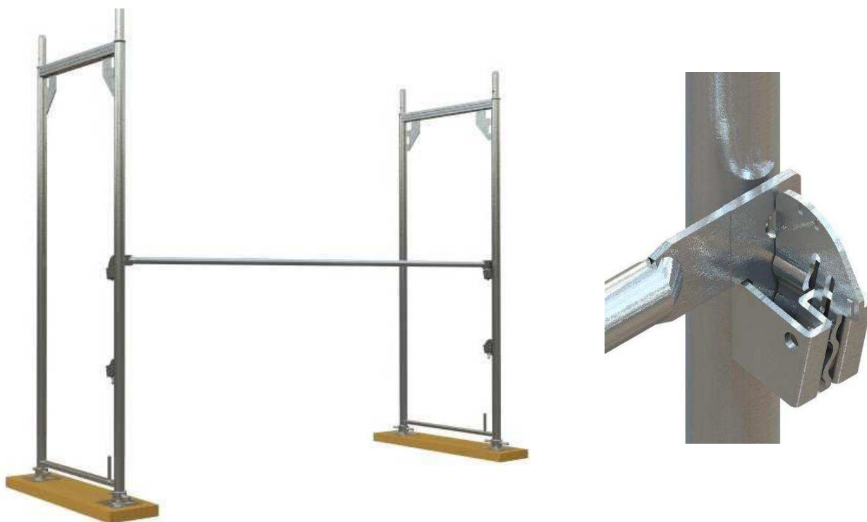
3. ábra A keretek és korlátok szerelése az első állványmezőben
