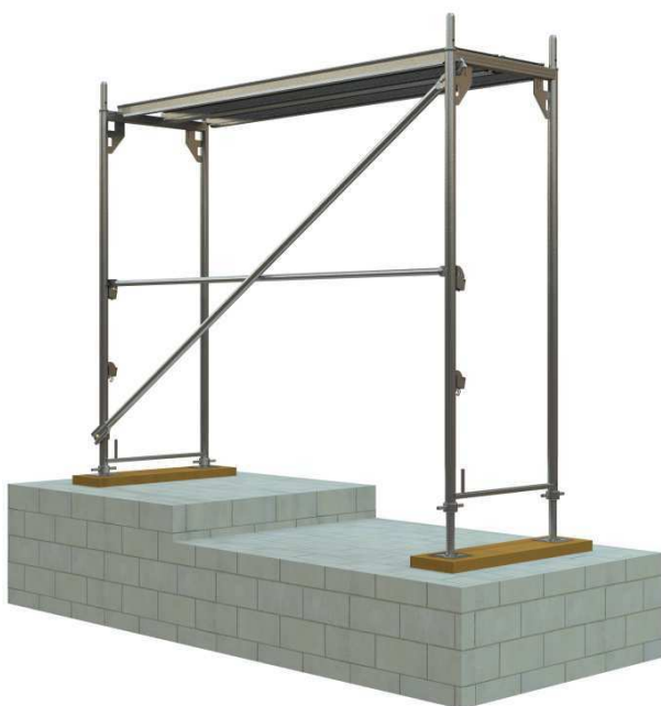
19. ábra Állvány szintezése: a) lábelemmel;
