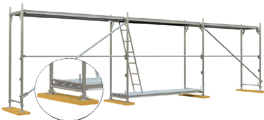
9. ábra Alapgerenda és acél járólap használata a létra megtámasztására az alsó állványszinten
