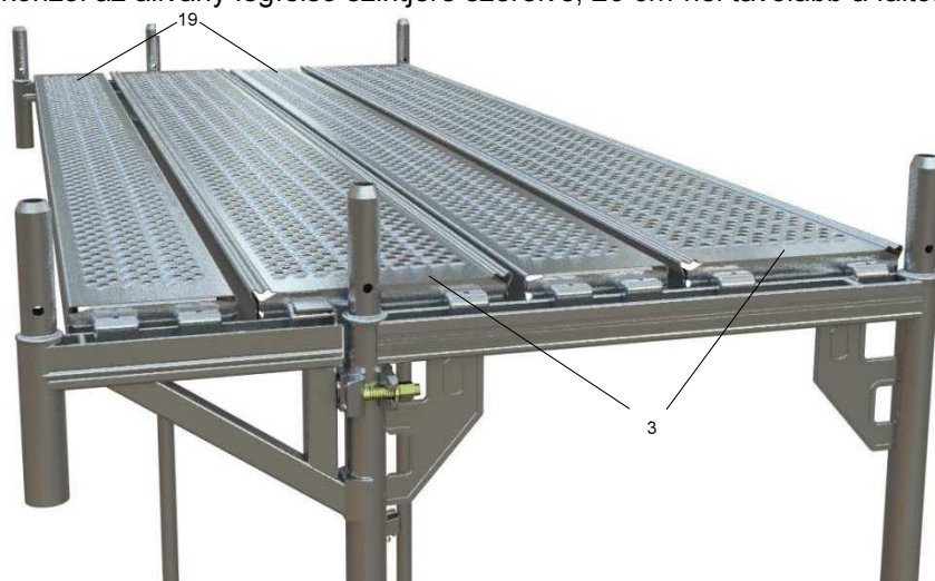
27. ábra Szoros illesztésű járólapok 0,36 m konzol szerelésénél - 0,32 m és 0,19 m járólapok használatával
