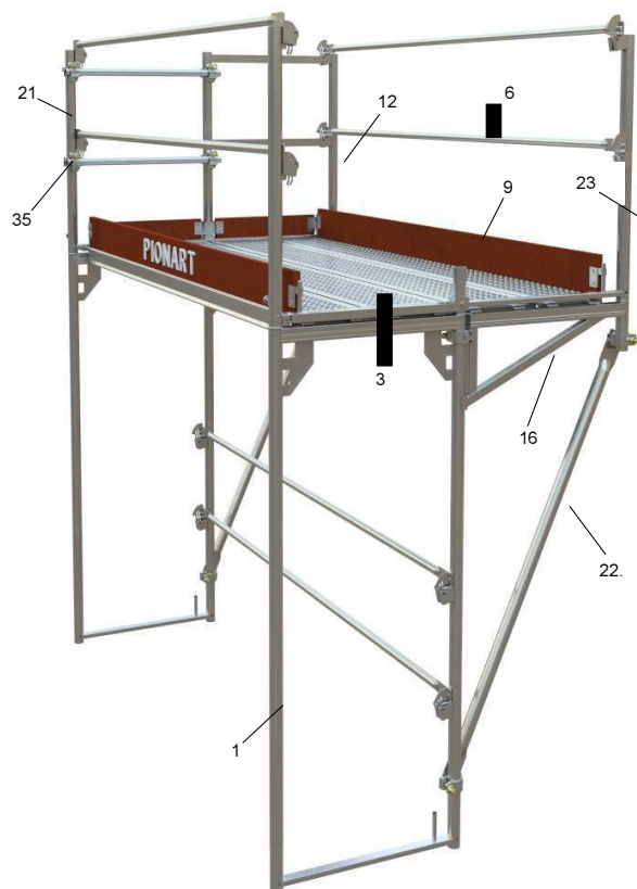
28. ábra 0,73 m konzol a legfelső állványszint külső szélesítésére:
