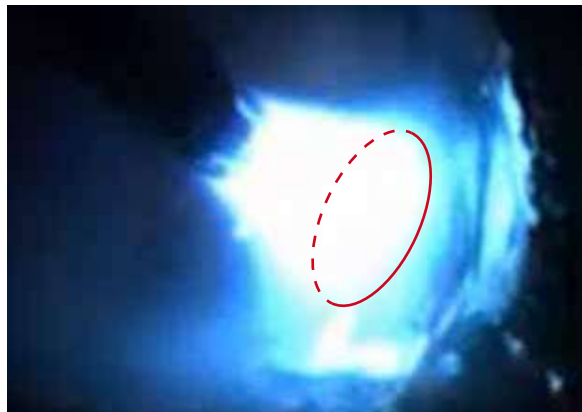
Most: FOCUS.ARC eljárásváltozat. Koncentrált ív, az energia az ívoszlop közepén összpontosul
