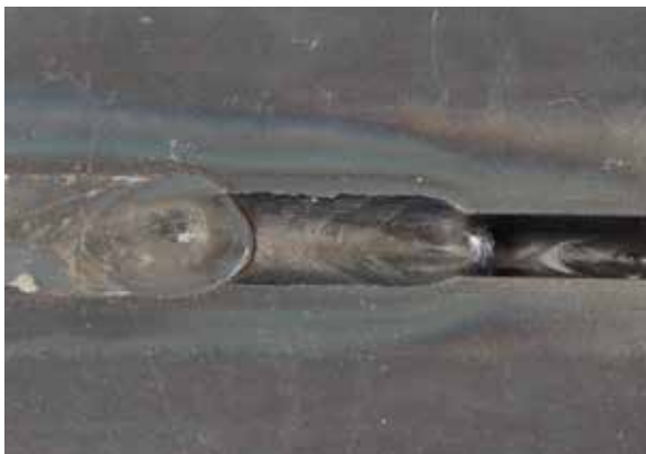
FOCUS.PULS -Többsoros varrat csökkentett nyílásszöggel (25°)
