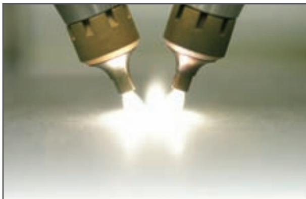
Plasmabeam Duo double nozzles system Plasmabeam Duo Doppeldüsenanordnung
