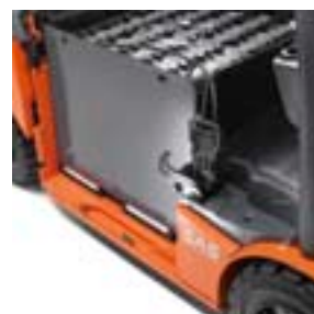
Oldalirányú akkumulátor kivétel görgős alátámasztással
