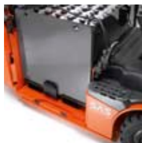
Oldalirányú akkumulátor kivétel villazsebek segítségével
