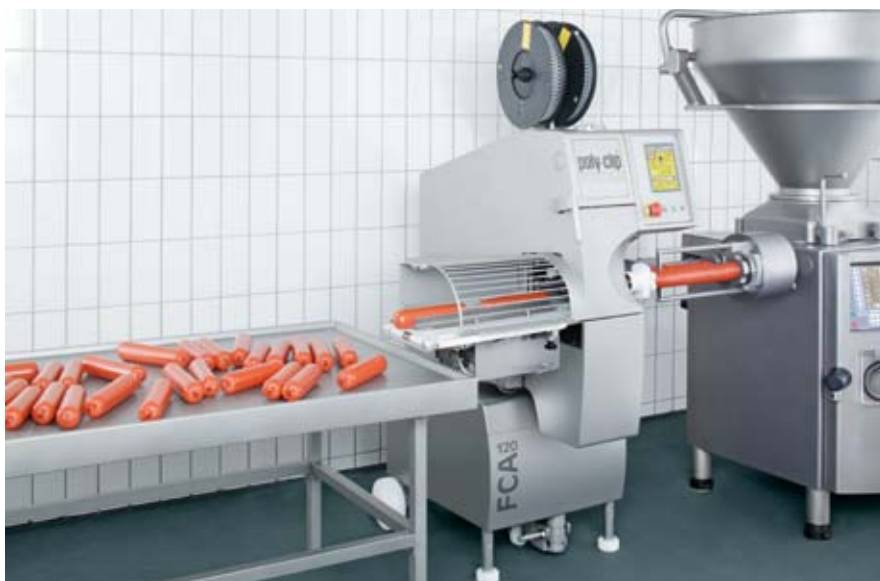
FCA 120 – der Spezialist für Höchstgeschwindigkeit im Kaliberbereich bis 120 mm
