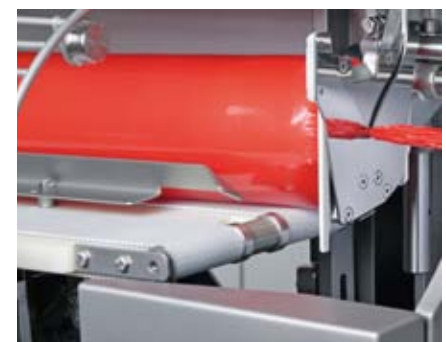
Überspreizung für luftfreie Lockerfüllung von Formprodukten
