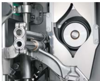
Vertikaler Linearverdränger - kurze Wurstschultern, brätfreie Wurstenden
