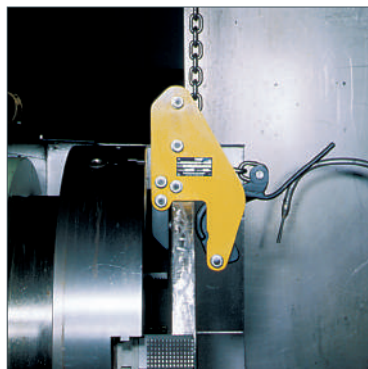
TWG modell módosított oldallemezekkel a szűk helyekhez (pl. esztergagép)
