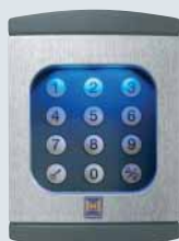
FCT 10b rádiós kódkapcsoló Az FCT 10b rádiós kódkapcsoló a CTR 1b és CTR 3b kódkapcsolókhoz képest az alábbi előnyökkel bír: egyszerű installáció, nincs szükség vezetékezésre, a max. 10 rádiós kóddal (868,3 MHz) legfeljebb 10 kapu működtethető.
