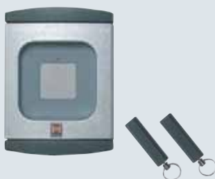
TTR 100, TTR 1000 transzponderkapcsoló A kapunyitás kényelmes módja: a személyes kódot tartalmazó transzponderkulcsot kb. 2 cm távolságra az olvasóegység elő kell tartani, érintés nélkül! Ez sötétben különösen előnyös. Max. 100 transzponderkulcshoz (TTR 100) ill. 1000 transzponderkulcshoz (TTR 1000) alkalmas. Két transzponderkulcs tartozik a készlethez.
