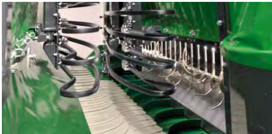
Pikkelyes termésfelfogó tűgörgős csapágyazással, rázószerkezet és levélfésű.
