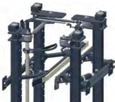
Oszlop-vezető és -érzékelő automata rázásmegszakítóval betonoszlopos szőlőültetvényekbe.
