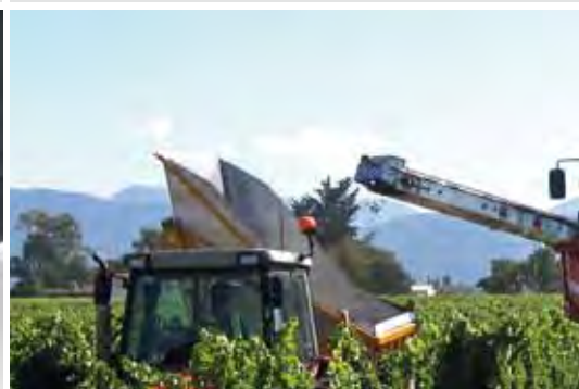
Az átrakószalag az 1500 literes szőlőtartállyal folyamatos oldal irányú ürítést tesz lehetővé hosszú sorok esetén.
