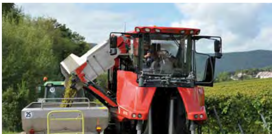
Az oldalirányú ürítésre jó a rálátás és mivel csak egy tartályt kell üríteni, így időt is spórolhatunk.
