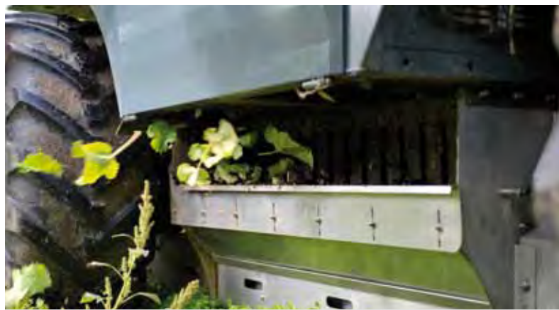
A levélfésű és a keresztáramú fúvó eltávolítja a leveleket mielőtt a szőlővel érintkeznének.
