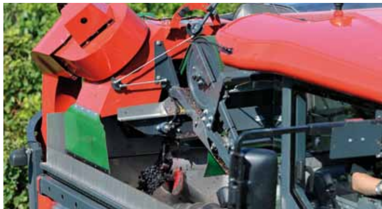
A bogyózó csak a legjobb minőségű szőlőt engedi a tartályba.
