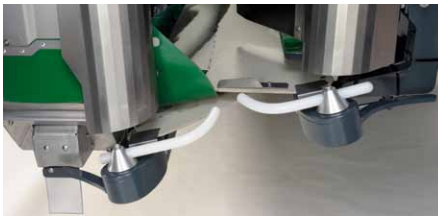
Automata kormányzás: a Grapelin 6000 biztonságosan halad a szőlősorok között.
