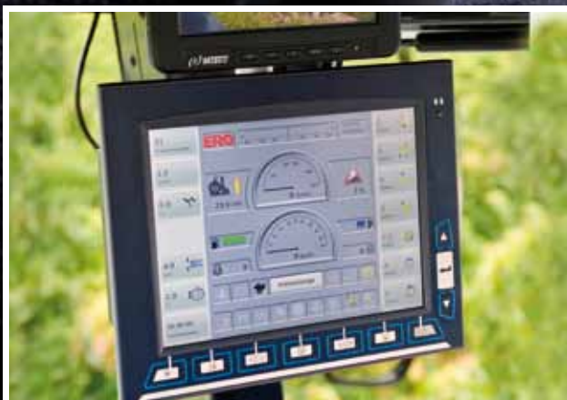
A színes, 10.4"-os kijelző egyszerű felületen mutat minden fontos paramétert.
