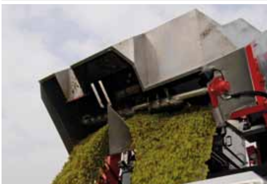
A szétválasztólemez segítségével a szőlőtartály két kisebb tárolóba is üríthető.
