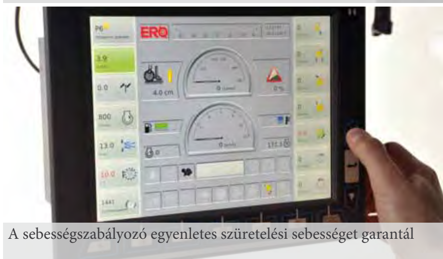
Magasságjelzés ultrahangos és mechanikus szenzorokkal.
