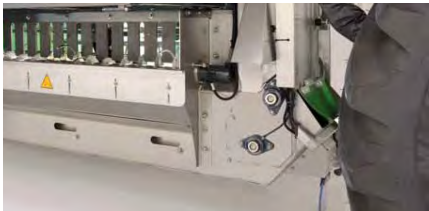
Magasságjelzés ultrahangos és mechanikus szenzorokkal.
