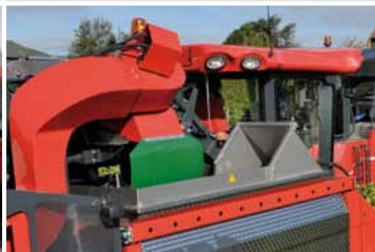
A tartályperem-szűkítővel szintén megoldható a kisebb tartályba ürítés.
