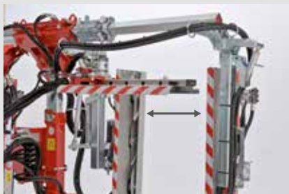
Manuális vágás szélesség állítás (15 – 85 cm)
