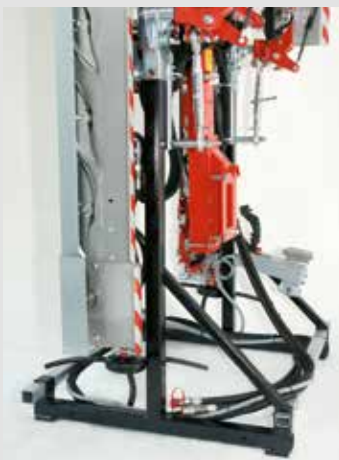
Állítótalp (csak a kétoldalú L Komfort Elite és a kétoldalú U alaku Komfortnál)
