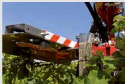
Ráfutó biztosítással a függőleges és vízszintes vágó lapoknál, gázrugóval és aktiválás után önbeálló.
