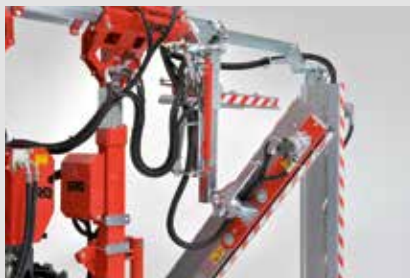
Ráfutó biztosítással a függőleges és vízszintes vágó lapoknál, gázrugóval és aktiválás után önbeálló.
