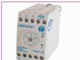
Feszültségfigyelő relé 3 fázisra, beállítható aszimmetriával és túlmelegedés elleni védelemmel
