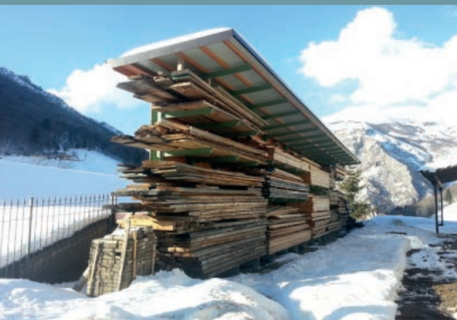
Tetővel fedett karos állványrendszer egy fűrészüzemben. Optimális szabadtéri tárolás.
