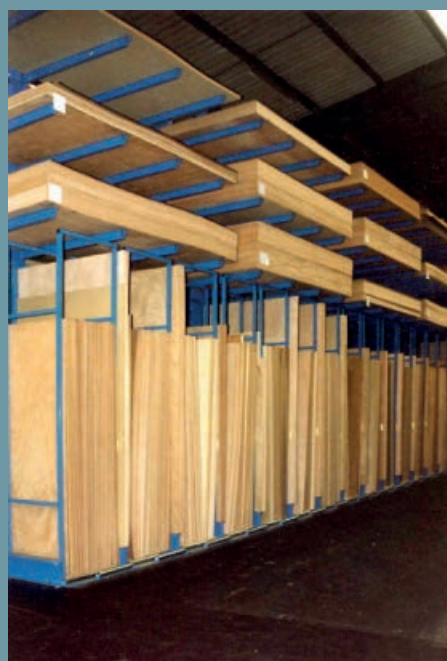
Beépített forgácslap polccal ellátott karos állványrendszerek kombinációja. Magas tárolási sűrűség minimális alapterületen.
