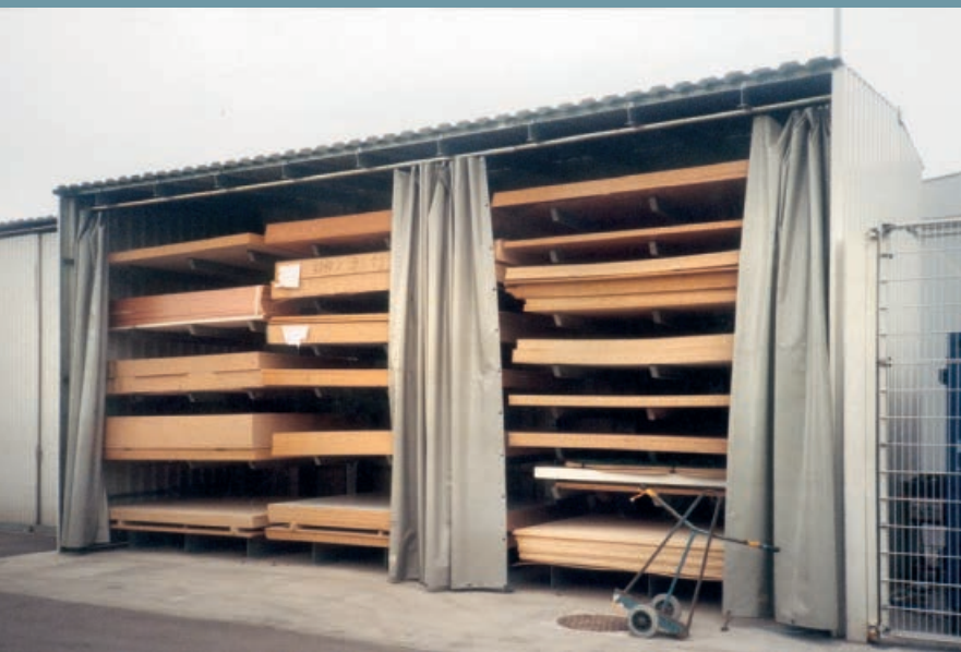
Egyedi tárolási megoldás alapokhoz: Tetővel és falal ellátott karos állványrendszerek, illetve függöny építettőirésről az eső vagy hó elleni védelemhez.
