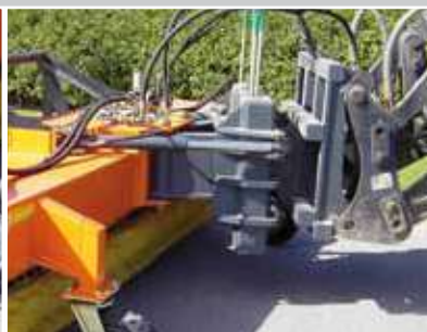
optimale Boden Anpassung durch robusten 3D-Niveaueausgleich
