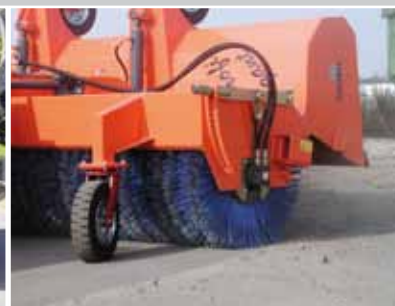
einfache Bürstennachstellung über Rasthebelsystem
