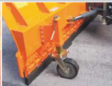
stufenlose Einstellung der Markenstützräder
